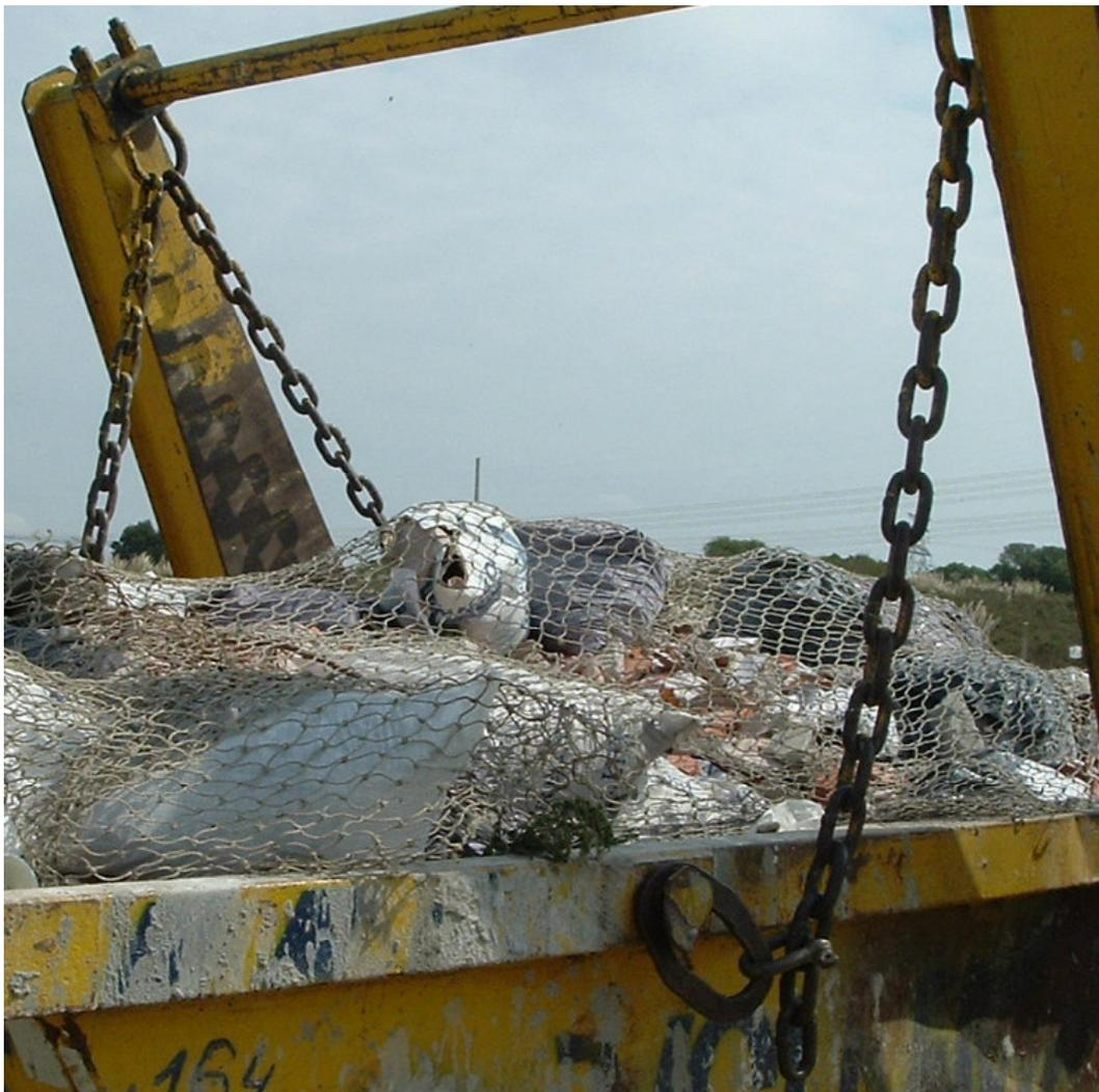
Todas las volquetas son de hierro, sin recubrimiento interior y pintadas en su exterior identificando a la empresa propietaria. El estado de conservación de las volquetas es variable al no existir, o no aplicarse, criterios mínimos para la aceptación de las mismas como medio de transporte de los residuos. Esta situación implica a su vez que la estanqueidad del recipiente no siempre esté garantizada.
